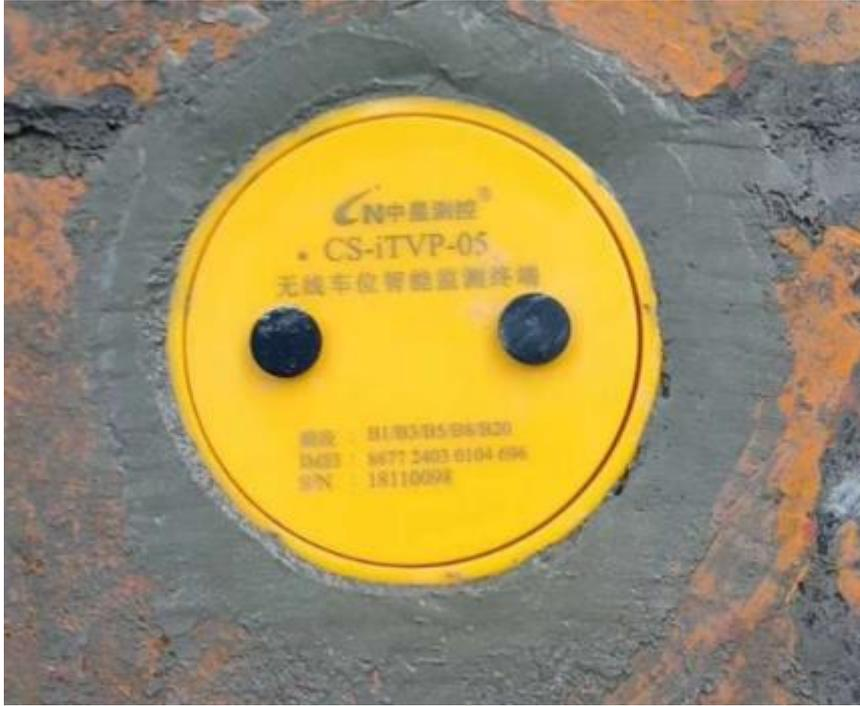
图 8 地埋式终端的安装效果图 (b)
